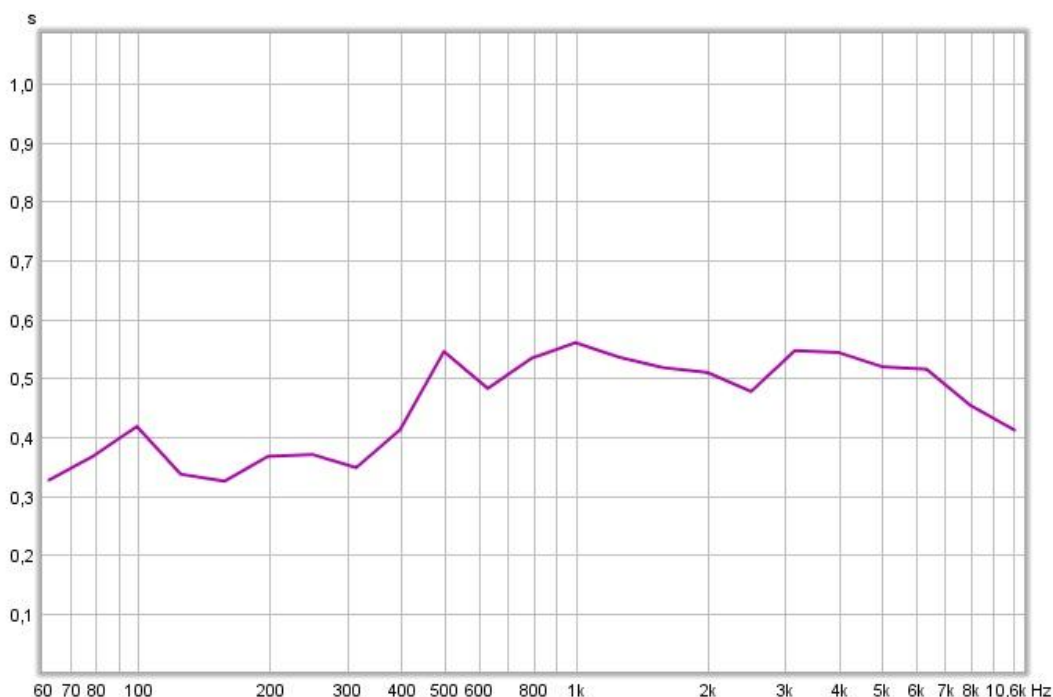
Rysunek 1 – Charakterystyka czasu pogłosu (pomieszczenie przed adaptacją)
